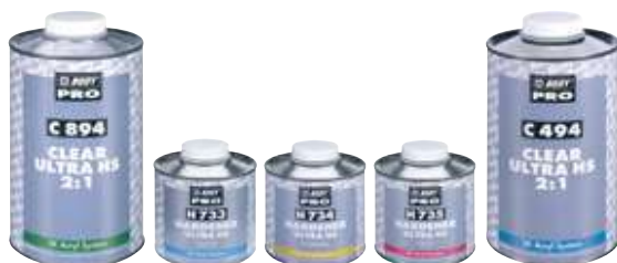
С 894 ЛАК ULTRA HS 2:1 ULTRA HS лак относящийся к 2К-Акриловой системе, предназначен для полной или локальной высококачественной окраски. Используется с отвердителем Н 734 NORMAL, Н 735 FAST и Н 733 SLOW в соотношении 2:1. Упаковка: 1 л, 5 л Цвет: Прозрачный
